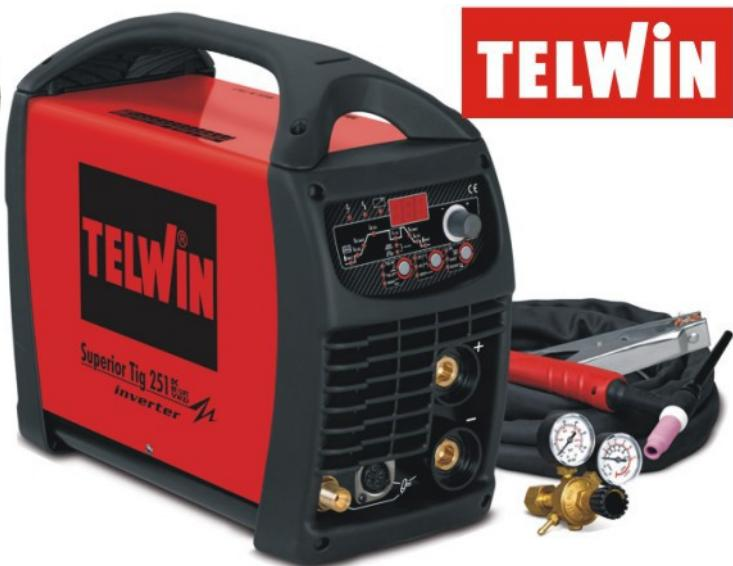
Superior 251 je svářečka určená pro metodou TIG DC (stejnosměrný proud) a obalené elektrody. Svářečka je vhodná pro náročné montážní práce v terénu, kde je vlhký nebo mokrý podklad. Metoda TIG DC - svařování ocelí a nerez ocelí stejnosměrným konstantním, nebo pulsním proudem wolframovou elektrodou v ochranné atmosféře argonu s vysokofrekvenčním zapalováním oblouku.
